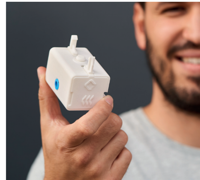
Skalierbarer Greifer aus dem 3D-Drucker (SLS-Verfahren), Joint-Venture Entwicklung der layer-manufactory GmbH und Bayer GmbH & Co KG., präsentiert von Tim Riedmüller.
