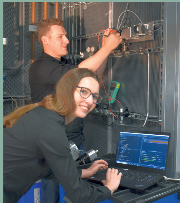
Messsensorik zur Ermittlung der Gasqualität am Motorprüfstand der Hochschule Ansbach
